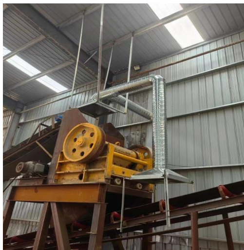
图 7 破碎机进出口集气罩
